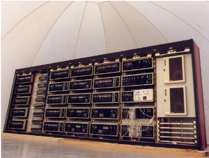
Photo 3 – Maquette de l'OCB283 en cours d'essais climatiques et de sensibilité électromagnétique (dans le dôme)
