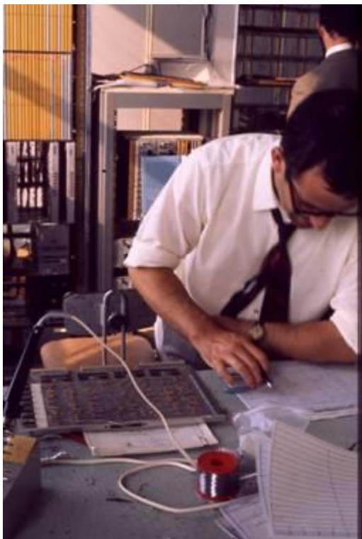
Photo 1 – ELS : un programmeur à l'œuvre (fer à souder, pincettes coupantes...)
