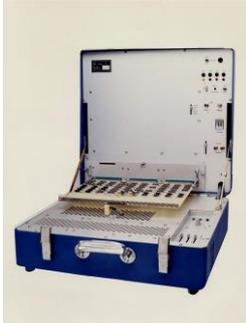
Nom = ? . Testeur des bases de temps de l'OCB181, développé par le labo techno.
