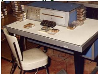
TREGOR : Testeur de RELais ... Rampe (Manu et Bodin se souviennent du reste). Initialement développé pour tester les relais équipant les cartes du CSA
