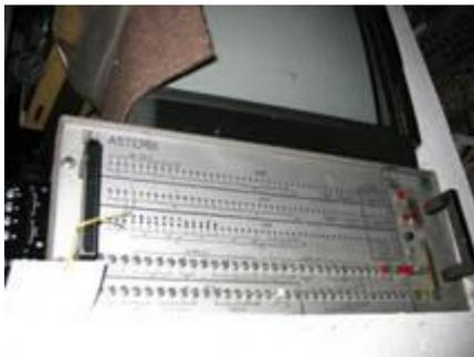
Peu de simulateurs sont disponibles pour valider le produit en interne: ASTERIX pour la matrice de connexion quoique le technicien de validation préfère brancher une sonde d'oscilloscope sur le fond de panier pour constater le bon effacement des connexions lors du raccrochage des abonnés.
