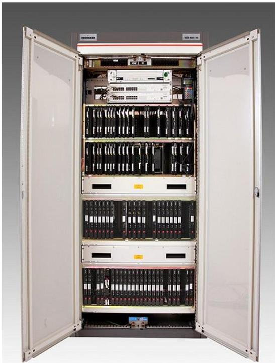
Ce produit annonce la fin du TDM (Time division Multiplex) donc des canaux à 64kB/s des MIC et conduit, en tout IP, à ne plus utiliser les matrice de connexion RCH, ni la gestion sémaphore de l'ITU n°7; le service équivalent est rendu par les Gateways.
