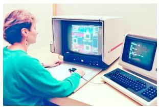
On procéda alors à une étude des logiciels d'implantation/routage disponibles sur le marché en parallèle avec des essais du produit Dédale développé à Vélizy. Le produit retenu fut le logiciel du commerce SCI-Cards. Le gain en temps et sécurité fut spectaculaire.
