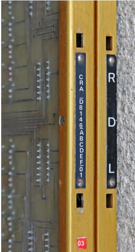
Jusque là, les cartes étaient identifiées par une étiquette aluminium rivée sur leur bandeau. Sur cette étiquette figurait seulement un sigle identifiant la fonction logique réalisée. (ex. RDL = Registre à Décalage Long)
