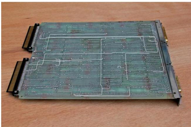
Dans un souci de qualité, les liaisons additives (straps) qui initialement étaient réalisées sous forme tendue entre les picots des composants, ont été réalisées parallèlement aux pistes de circuit imprimé et collées sur le circuit.
